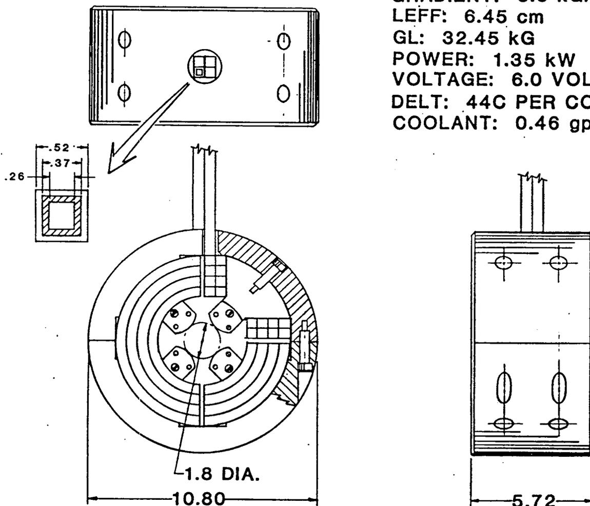
MINIMUM SIZE DRIFT TUBE LINAC QUADRUPOLE
